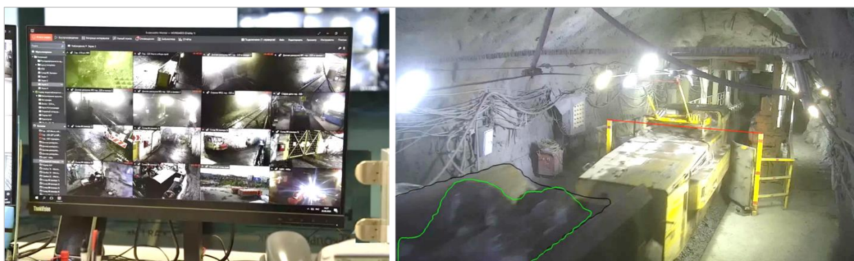
Рисунок 12.3 - Система видеоаналитики «Рудопоток», которая позволяет контролировать транспортировку руды и показатели качества сырья.
