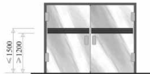
Размещение предупреждающей маркировки на двукопальной стеклянной двери
