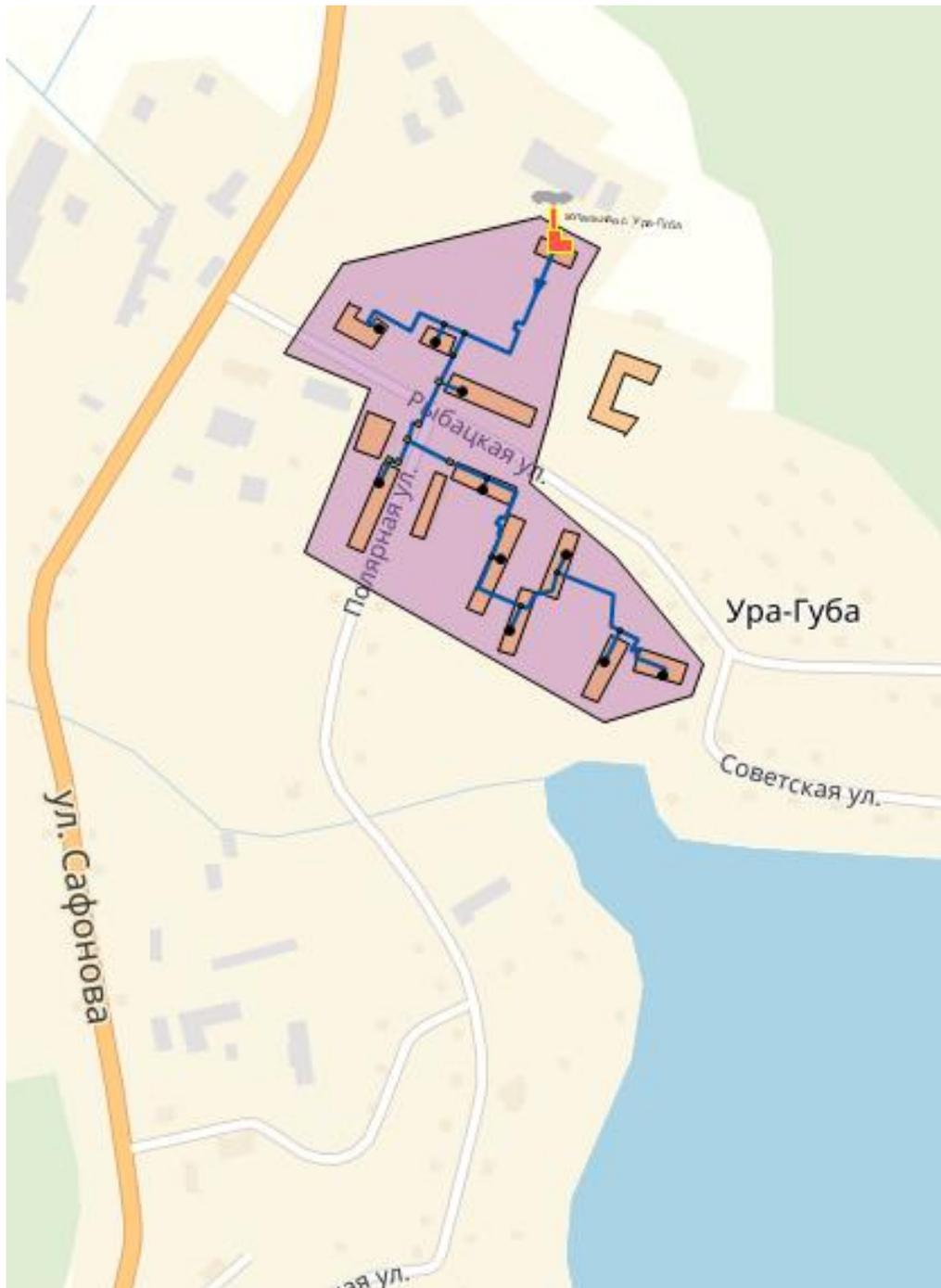
Рисунок 1 - Зона действия централизованного теплоснабжения от Котельной «Ура-Губа»
